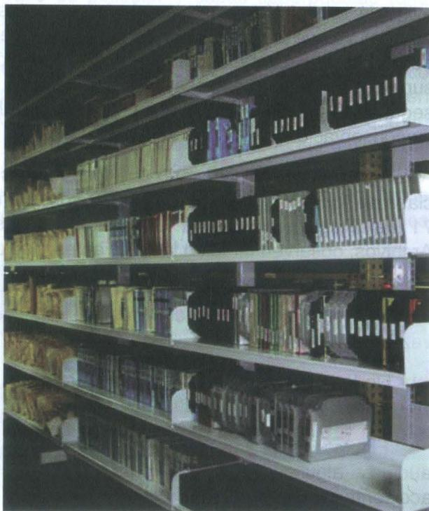
*Estantería metálica esmaltada para la conservación de material magnetofónico (cintas de carrete abierto).*
